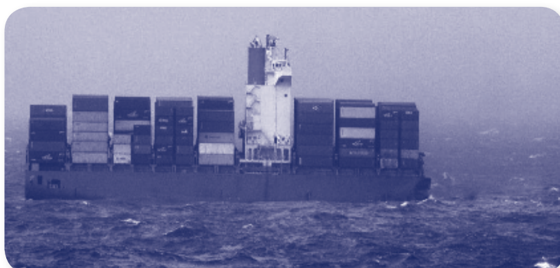
Figura 5. Mitad posterior del portacontenedores después de la rotura del casco
