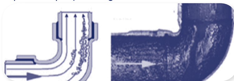
Figura 13. Desgaste por erosión
