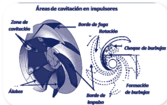
Figura 15. Cavitación en impulsor o impeler de bombas
