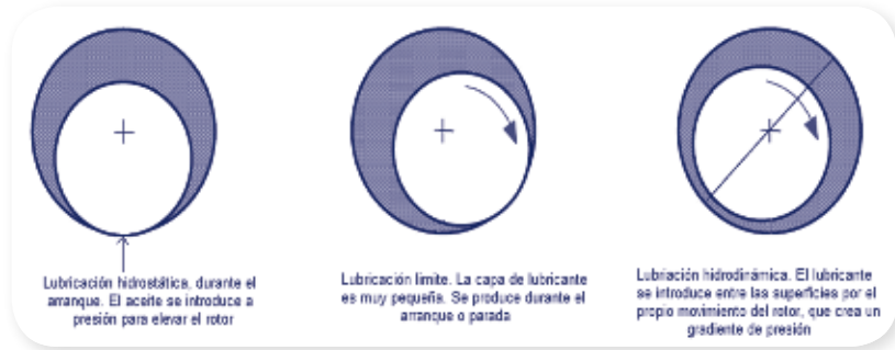
Figura 18. Lubricación hidrostática, límite e hidrodinámica
