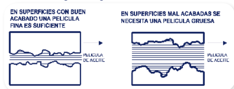
Figura 16. Influencia del acabado superficial en espesor de película aceite
