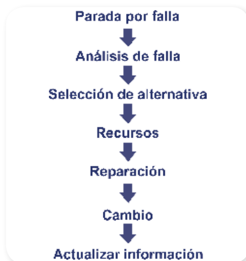
Figura 8. Mantenimiento Correctivo Fuente: Ing. Javier Eduardo Murcia Gómez
